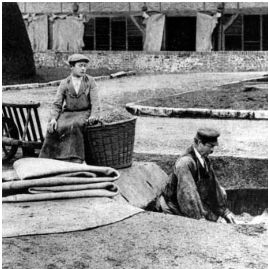
Un coucheur et un jeune ouvrier, prêt à « servir la poudre » contenue dans une grande corbeille d'osier, à Château-Renault (Indre-et-Loire). Carte postale, v. 1900.
