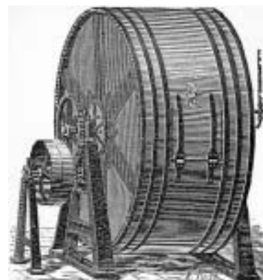
Le tonneau à fouler, utilisé lors du travail de rivière, le tannage, la nourriture des cuirs ou leur teinture ; in : P. Puget, Cuir et peaux , 1908.
