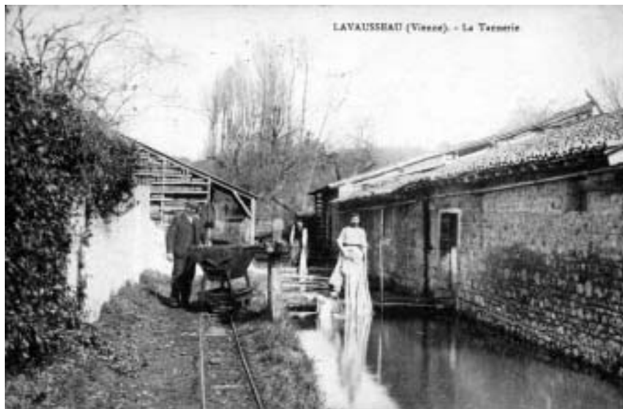
La trempe des peaux dans la rivière ; tannerie de Lavausseau (Vienne). Carte postale, v. 1910. Coll. L. Bastard.
