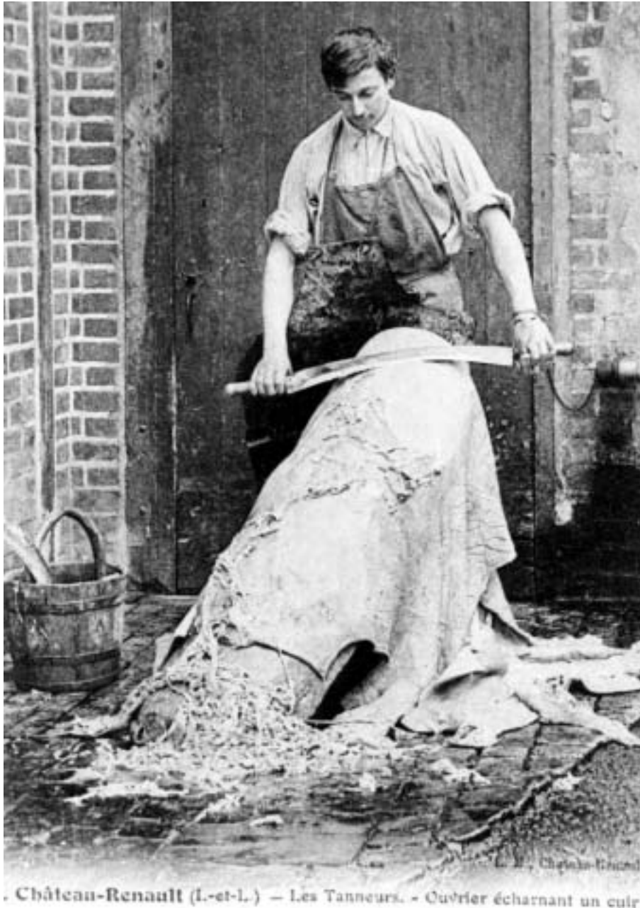
Écharnage sur chevalet, à Château-Renault. Carte postale, v. 1900.
